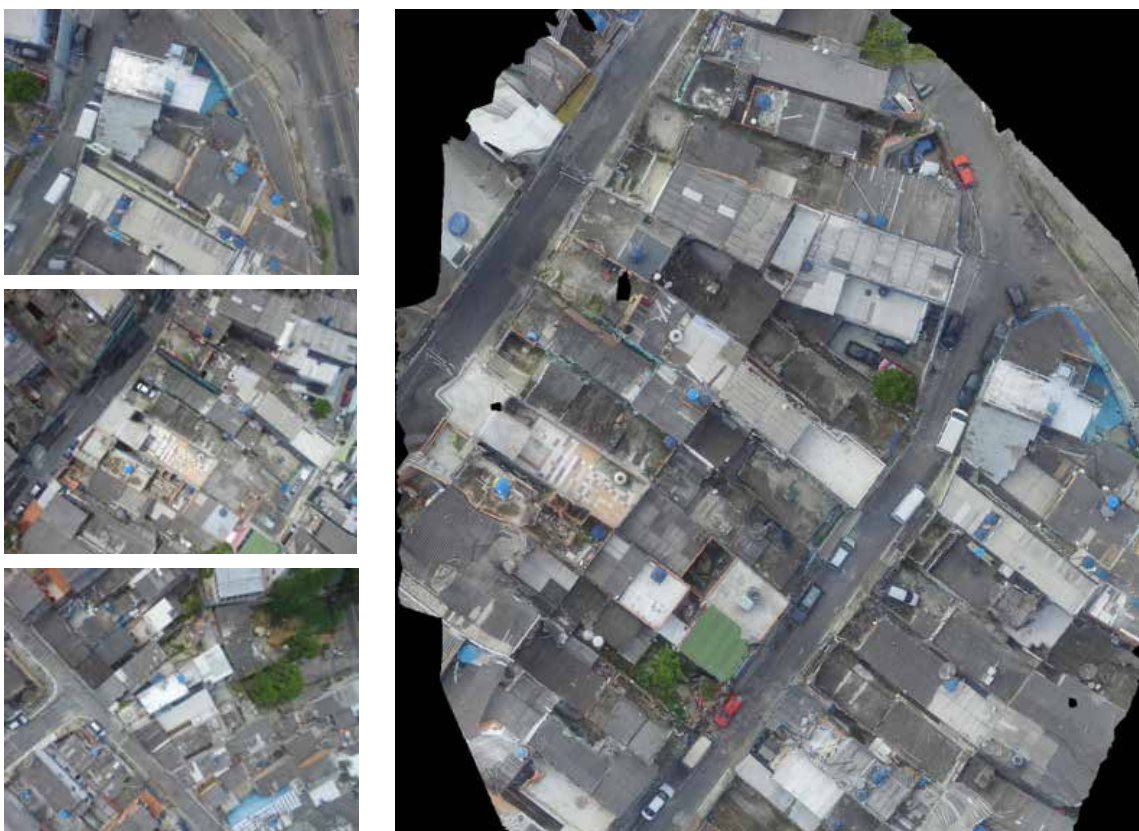
Fig. 2. Exemplos de imagens adquiridas por drone e composição do ortomosaico. Fonte: UNINOVE; elaboração dos autores.
